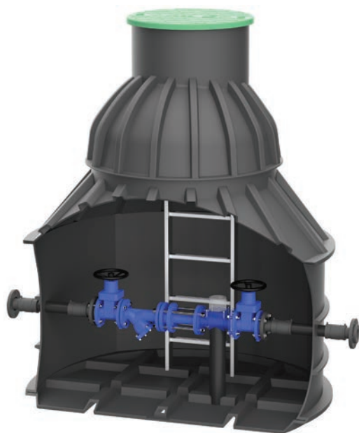
Vodomerni jašek tip DN/OD 1600/625 z ekscentričnim konusom, PE pokrovom polnjenim s poliuretanom in osnovno opremo
