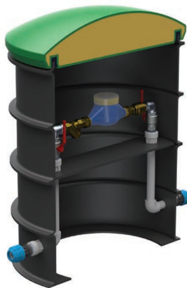
Vodomerni jašek tip DN/ID 800 s PE kupolo polnjeno s poliuretanom in osnovno opremo
