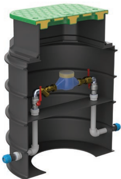
Vodomerni jašek tip DN/ID 1000 z revizijsko odprtino 750 x 750 mm, PE pokrovom polnjenim s poliuretanom in osnovno opremo
