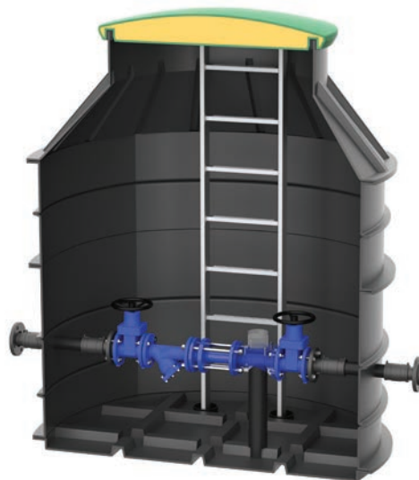
Vodomerni jašek tip DN/OD 1600/1000 z ekscentričnim konusom, PE kupolo polnjeno s poliuretanom in osnovno opremo
