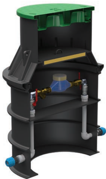
Vodomerni jašek tip DN/ID 800/625 s centričnim konusom, PE pokrovom, PE vstavek polnjen s poliuretanom in osnovno opremo
