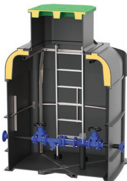
Vodomerni jašek tip D/W/H 1500 x 1500 x 2300 z revizijsko odprtino 750 x 750 mm, s PE pokrovom polnjenim s poliuretanom in osnovno opremo
