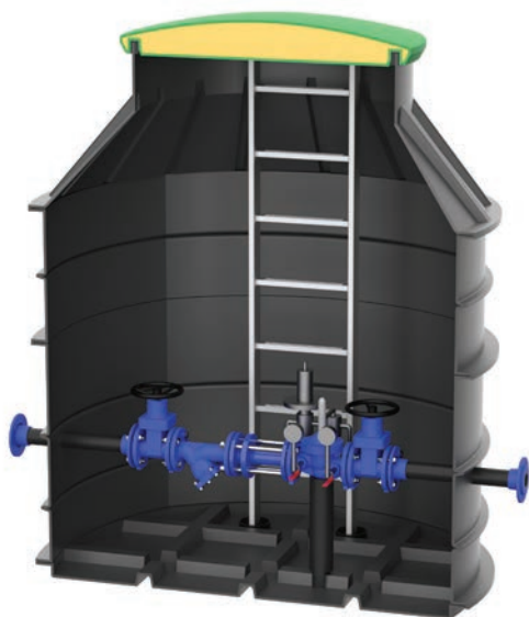
Armaturni jašek tip DN/ID 1600/1000 z inštalacijo DN 50 v sestavi 2 x EV zasun, lovilec nesnage, MDK in reducirni ventil.
